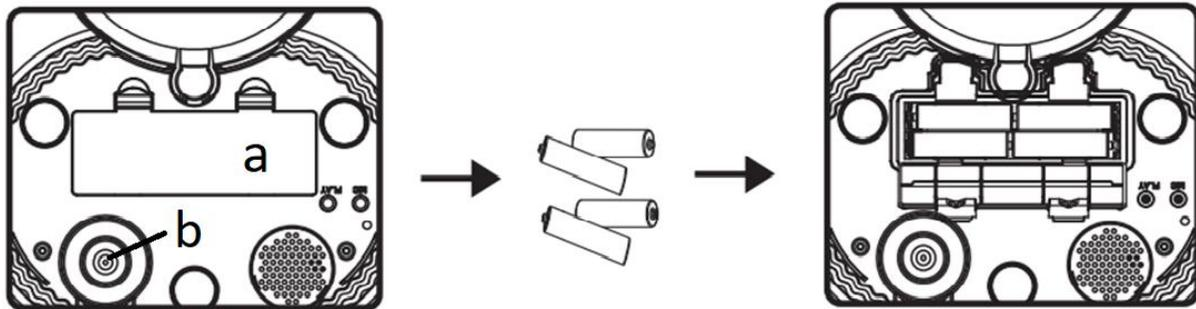
1. Setzen Sie vier Batterien in das Batteriefach (a) ein. Achten Sie bitte auf die korrekte Ausrichtung. Die Batterien fungieren als Backup und werden bei einem Stromausfall automatisch verwendet. Schließen sie das USB-Stromkabel (b) an.
