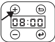
1. Drücken Sie kurz die **Plus-Taste**, um das Gerät zu aktivieren (Uhrzeit leuchtet).
