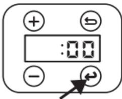
4. Drücken Sie kurz die **Weiter-Taste**. Die Anzeige schaltet auf Minuten um.
